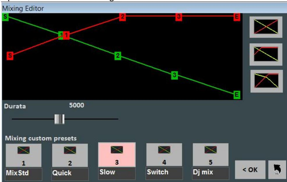
Con il mixing editor si può impostare l'andamento e la durata (in milli-secondi) del Cross-Fade, cioè del mixing di due brani Audio.
